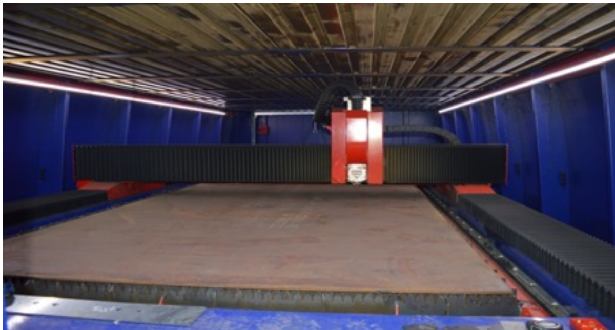
Laser 4kW s rozmerom stola 2000x6000. Rezanie hrúbok materiálu- Oceľ do hrúbky 20mm, Nerez do hrúbky 15mm, Hliník do hrúbky 12mm
