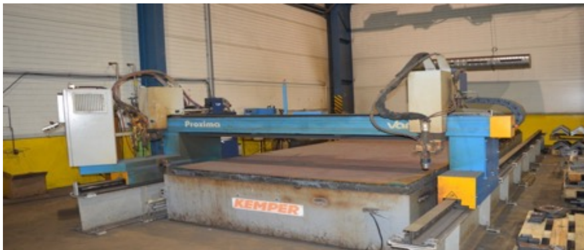
Plazma + 2 x kyslík. Rozmer stola 2000x6000mm. Rezanie materiálu do hrúbky 220mm
